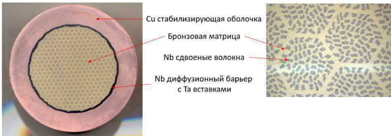
Рис. 1. Общий вид и фрагмент поперечного сечения стренда ДМ1,0
